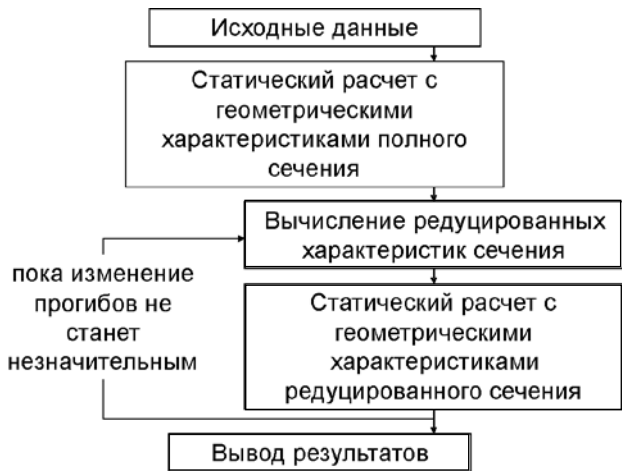
Рисунок 4 — Схема алгоритма вычисления прогибов при фиксированном уровне нагружения
