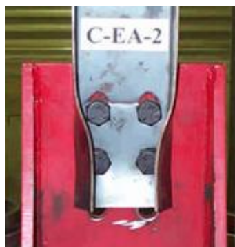
Рисунок 2.1.2 – Характерный вид разрушения испытанных в [15] образцов
