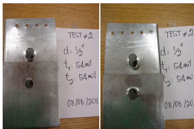
Рисунок 2.1.10 - Характерный вид исчерпания несущей способности в результате смятия t = 1,43 мм [20] (соединение без шайб)
