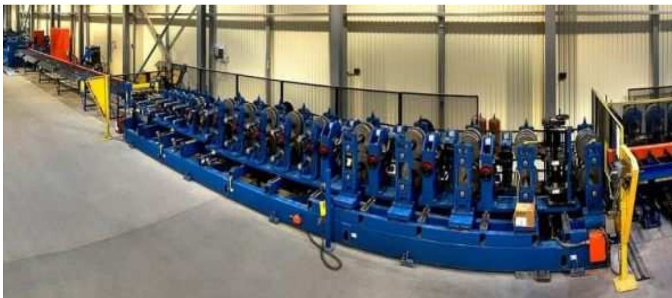
Рисунок 2.3 - Прокатный многовалковый (многоклетьевой) стан.
